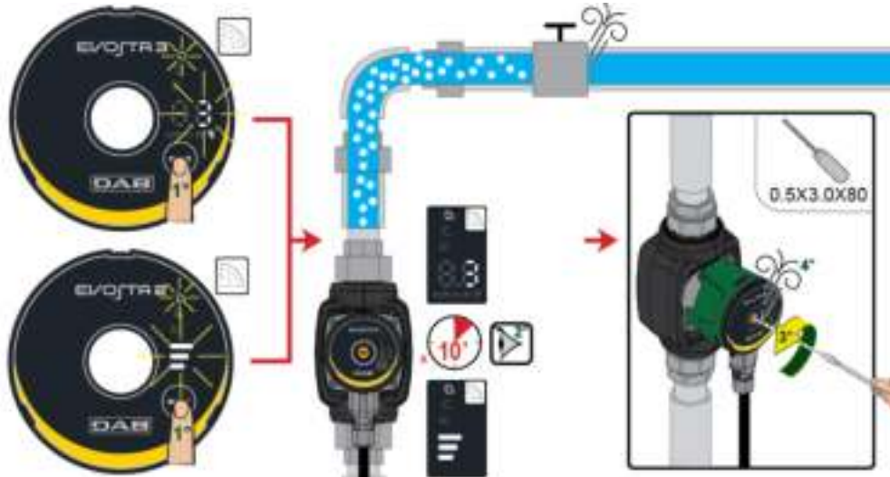
Fig. 8: Udluftning af pumpe
