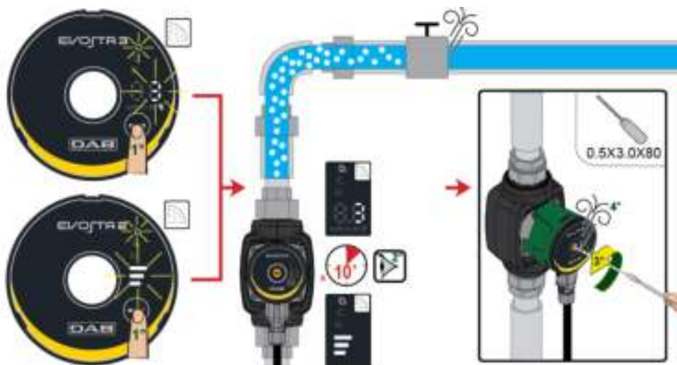
Afbeelding 8: Ontluchting van de pomp
