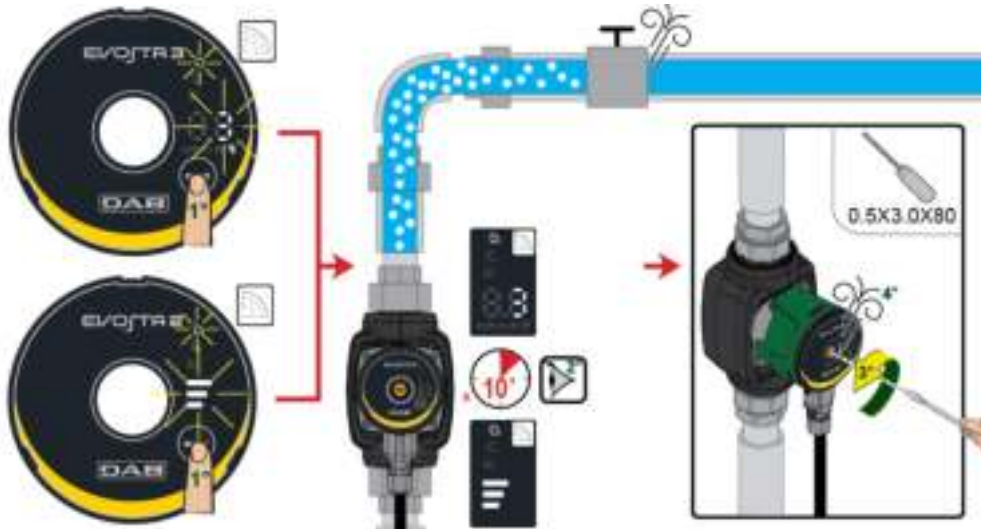
Joonis 8: Pumba õhutustamine
