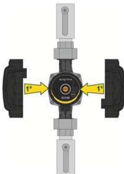
Figura 7: Izolare corp pompa
