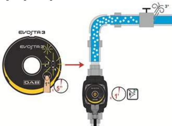
Fig. 9: Automatisk udluftning af pumpe
