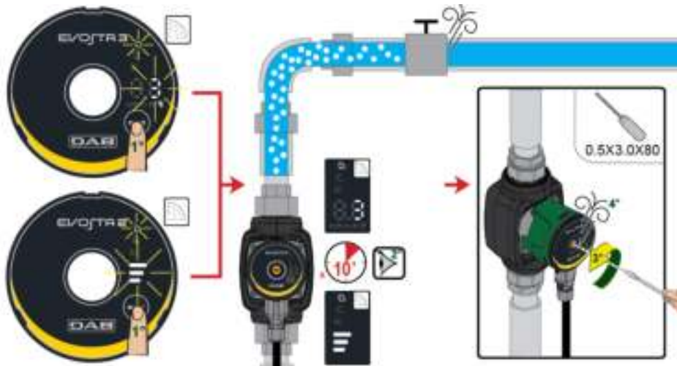
Figura 8: Sfiato della pompa
