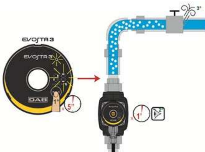
Attēls 9: Sūkņa automātiska gaisa izvadīšana
