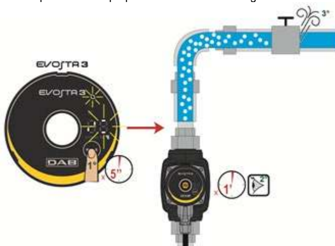
Figura 9: Purga automática de la bomba
