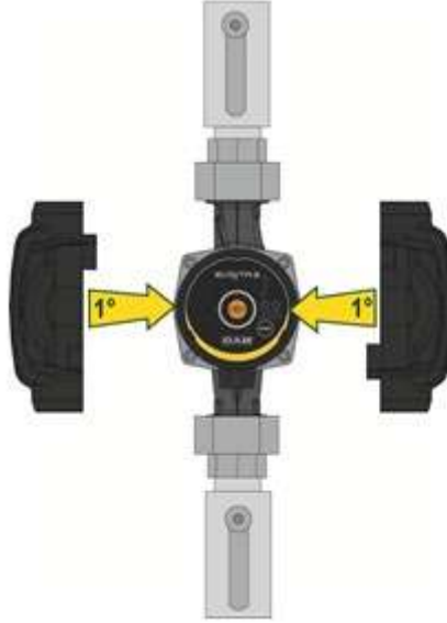
Resim 7: Pompa gövdesinin yalıtımı
