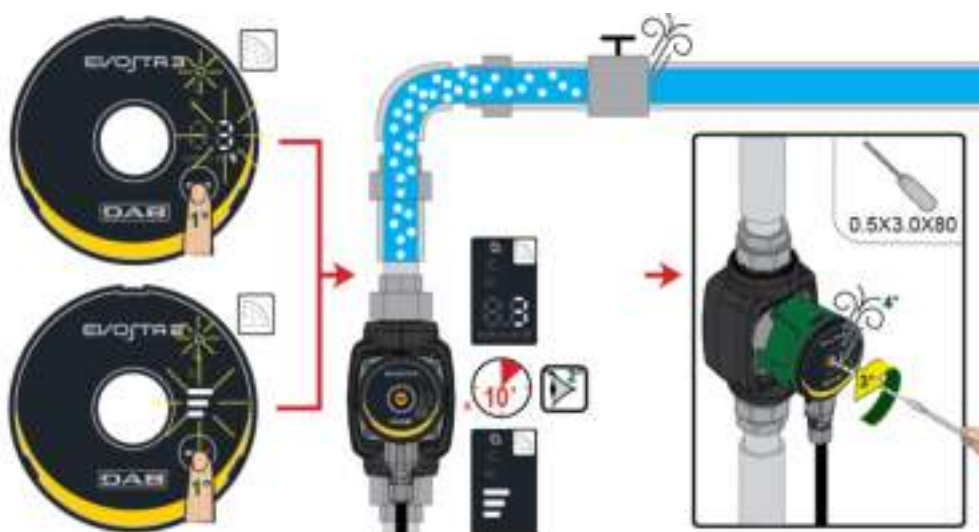
8 pav.: Oro išleidimas iš siurblio
