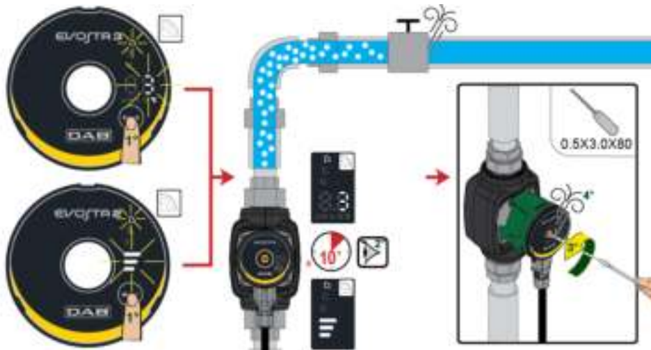
Εικόνα 8: Εξαέρωση της αντλίας
