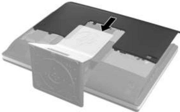
Afbeelding 2-33 Het toegangspaneel terugplaatsen
