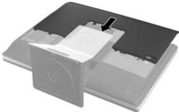
Afbeelding 2-29 Het toegangspaneel terugplaatsen
