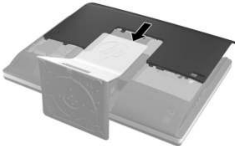
Afbeelding 2-56 Het toegangspaneel terugplaatsen
