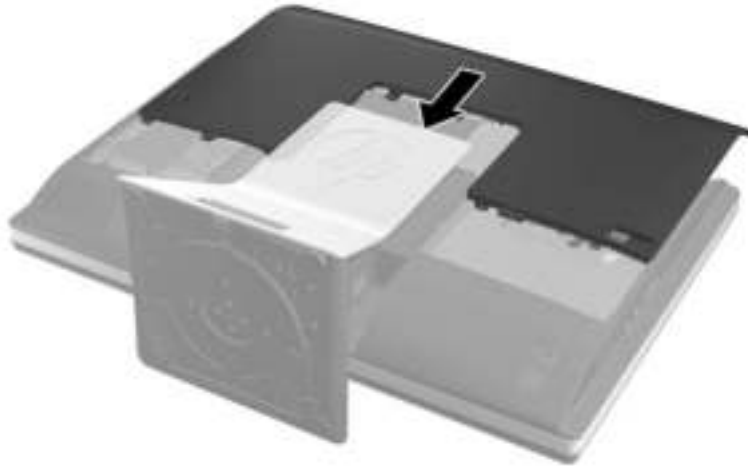
Afbeelding 2-50 Het toegangspaneel terugplaatsen
