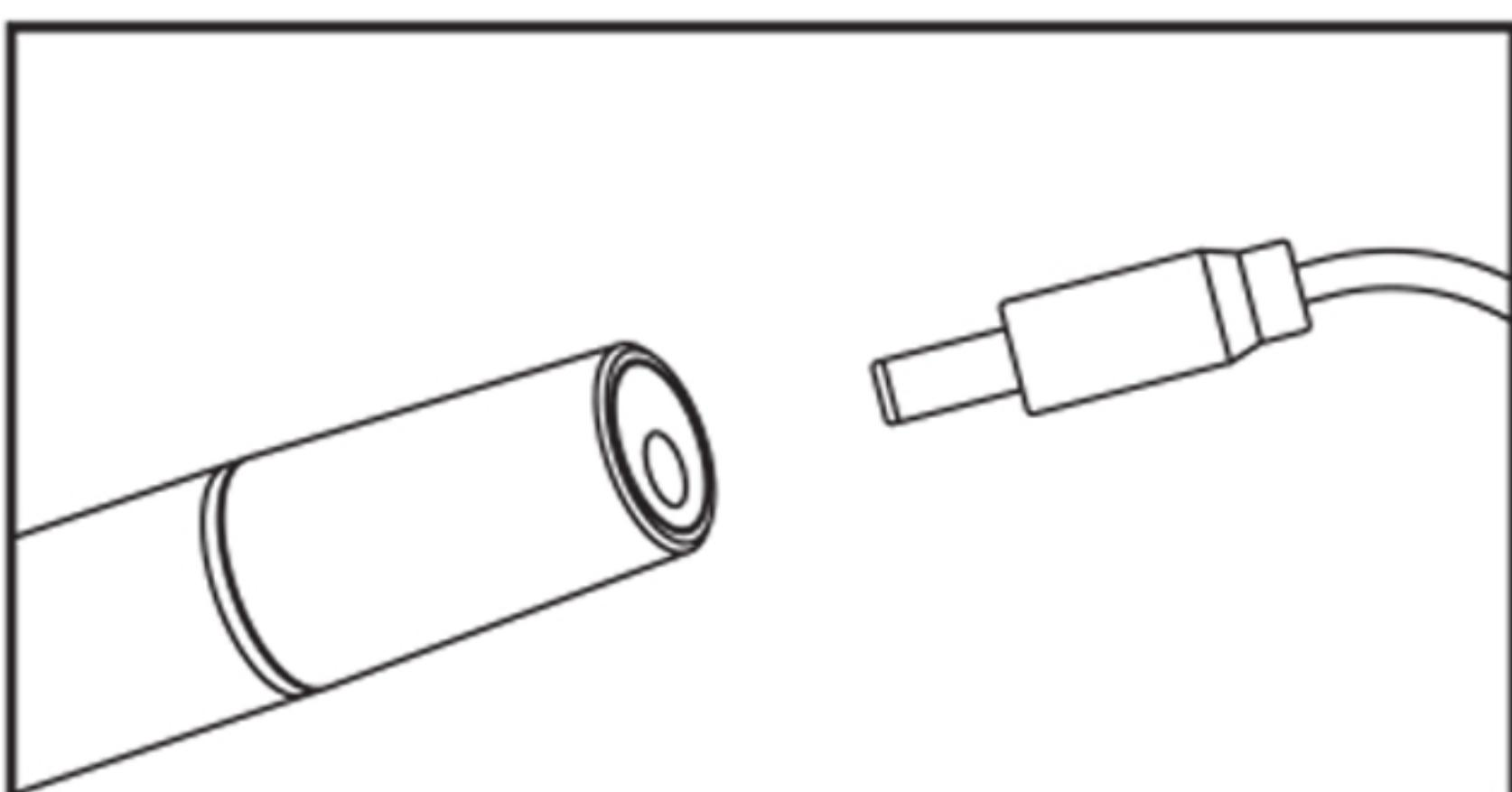
**Étape 3.** Connectez la fiche DC du câble USB à la ponceuse à ongles et l'autre extrémité à un adaptateur USB (pour téléphone) ou à une batterie externe (DC 5V/2A). Adaptateur et/ou batterie externe non inclus.
