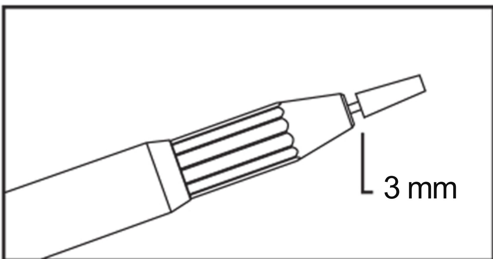
**Étape 2.** Insérez avec une distance d'environ 3 mm entre le trou avant de la ponceuse à ongles et l'accessoire.
