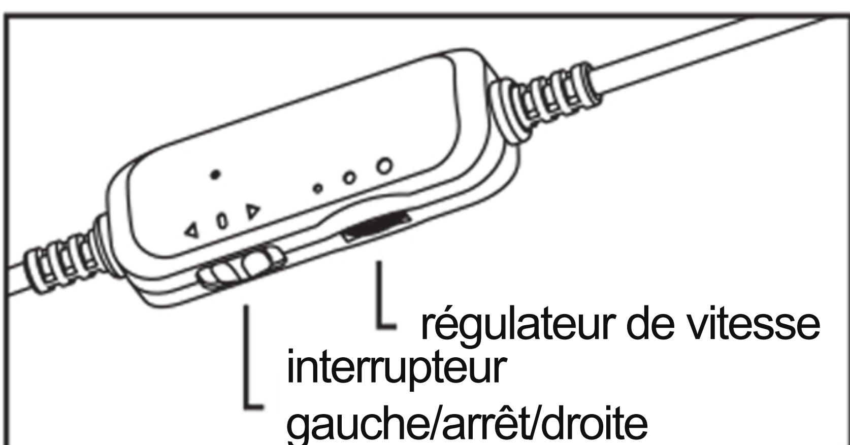
**Étape 4.** Utilisez l'interrupteur gauche/arrêt/droite au milieu du cordon électrique pour allumer ou éteindre la machine.
