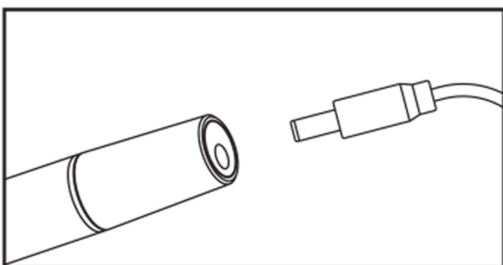
**Stap 3.** Verbind de DC-stekker van de usb-kabel met de nagelfrees en het andere uiteinde met een USB-(telefoon)adapter of powerbank (DC 5V/2A). Adapter en/of powerbank niet meegeleverd.
