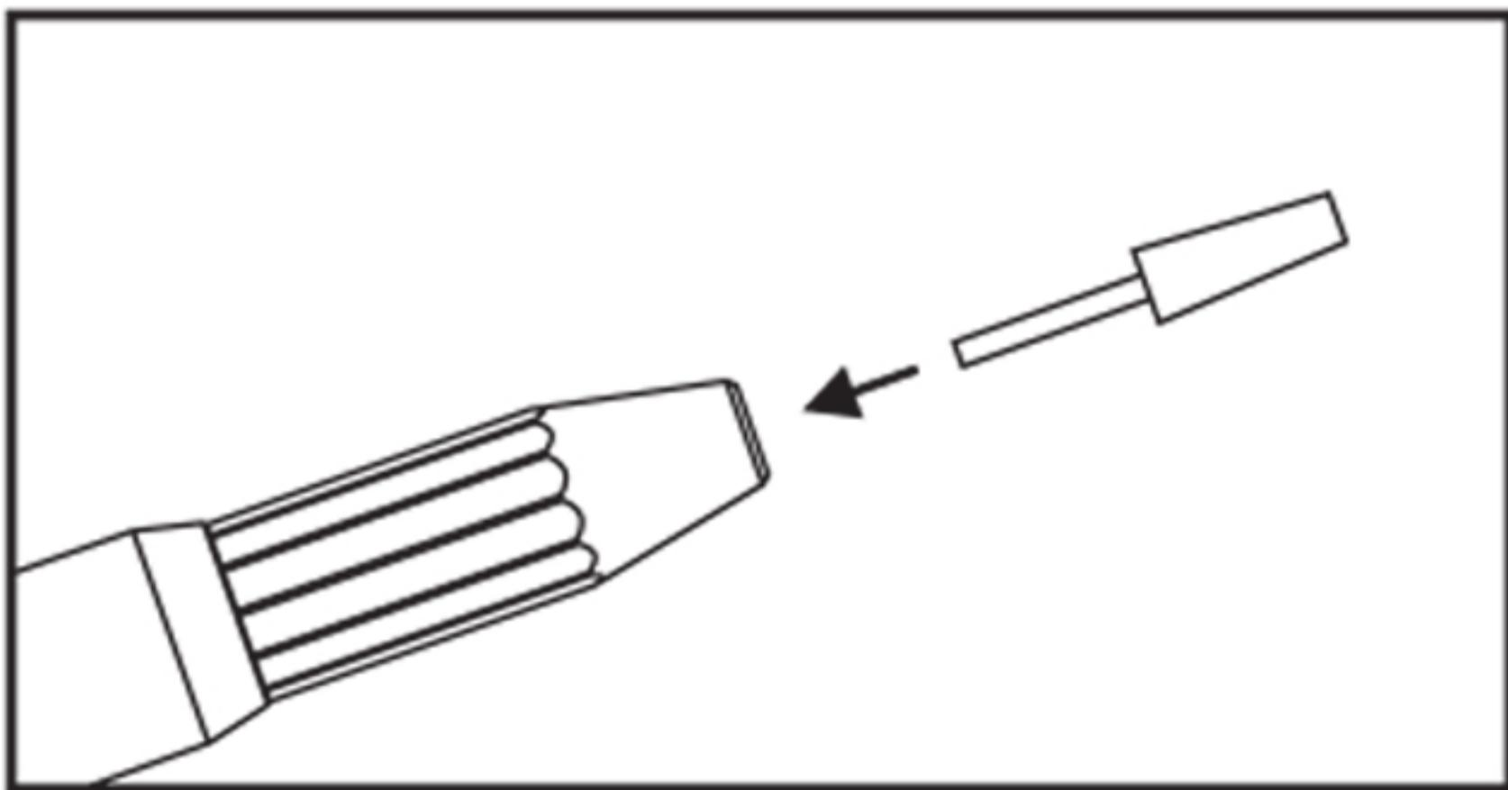
**Étape 1.** Choisissez le foret et placez-le dans le trou avant de la ponceuse à ongles.
