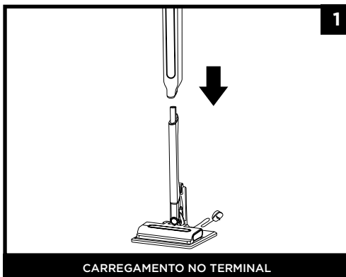
CARREGAMENTO NO TERMINAL
