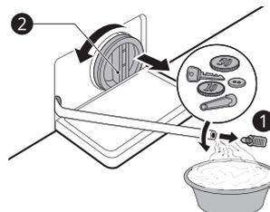
**4** Après avoir nettoyé le filtre de la pompe de vidange, le sortir et insérer le bouchon de vidange.
