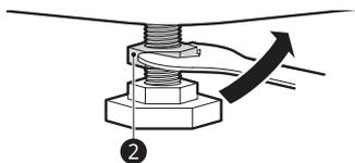
**4** Vérifiez que tous les écrous de blocage situés au bas de l'appareil sont correctement fixés.
