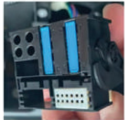
Originele voertuigstekker: vergelijk vorm, pinindeling en vergrendeling.
