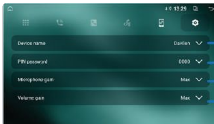
Bluetooth-instellingen: naam ( Device name ), pincode ( PIN password ), microfoongevoeligheid ( Microphone gain ) en gespreksvolume ( Volume gain ).
