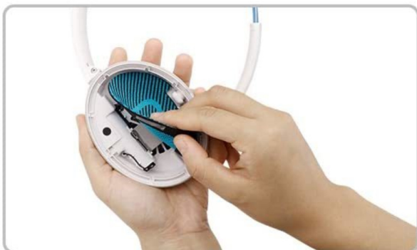
4. PLAATS HET STOFNET IN DE OORSCHHELP
