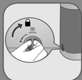
**FR** Remettez le bouchon anti-calcaire sur sa base, vissez le complètement et vérifiez qu'il n'y a pas de fuite.
