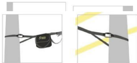
Gebruik ijzeren verbindingen (EN362) voor de verbinding (R>25kN).
