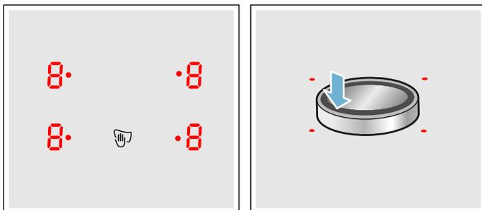
Der Twist-Knopf ist magnetisch und wird auf das Twist-Pad aufgesetzt. Durch Berühren des Twist-Knopfes im Bereich einer Markierung aktivieren Sie die entsprechende Kochstelle. Durch Drehen des Twist-Knopfes stellen Sie die Kochstufe ein.
