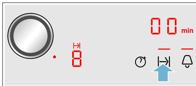
3. Dans les 10 secondes suivantes, réglez la durée désirée au moyen du bouton de commande Twist-Pad.
