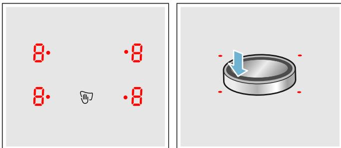
De twist-knop is magnetisch en wordt op het twist-pad geplaatst. Door de twist-knop in het gebied van een markering aan te raken activeert u de betreffende kookzone. Door de twist-knop te verdraaien stelt u de kookstand in.
