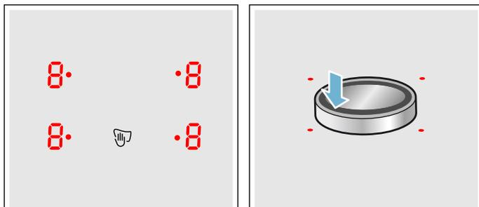
Le bouton Twist est magnétique et se pose sur le Twist-Pad. En effleurant le bouton Twist au niveau d'un repère, vous activez le foyer correspondant. Vous réglez la position de chauffe en tournant le bouton Twist.
