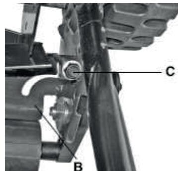
**Aanwijzing:** Het afstellen van het vaste mes (B) dient alleen te gebeuren vóór het eerste gebruik of indien de messen van de maaispil versleten zijn. Draai aan weerskanten de afstelmoeren (C) open en stel het vaste mes op de gewenste positie af. Het vaste mes (B) is correct afgesteld als u een stuk papier tussen de messen van de maaispil en het vaste mes kan afknippen terwijl u het wiel met de hand naar voren draait.
