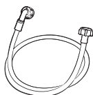
Tuyau d'arrivée d'eau froide
