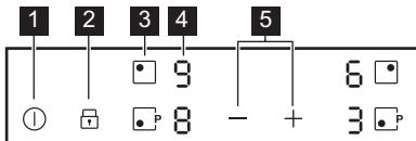
Gebruik de tiptoetsen om het apparaat te bedienen. De displays, indicatielampjes en geluiden tonen welke functies worden gebruikt.
