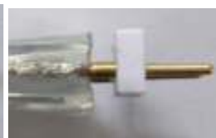
Vista laterale del connettore a 2 perni
