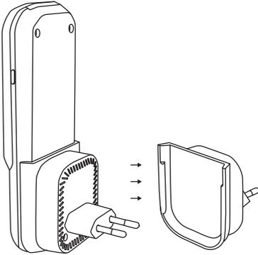
Lamplichaam en oplaadstation kunnen worden gescheiden. In de draadloze oplaadmodus, plaats het lamplichaam erop en laad het onmiddellijk op.
