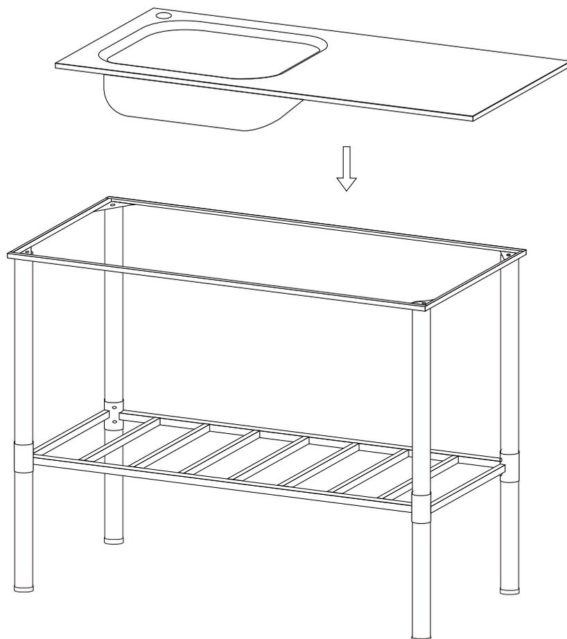
4. Montieren Sie das Bauteil „5“ gemäß der Zeichnung. Achten Sie auf den korrekten Sitz der Dichtungen.
