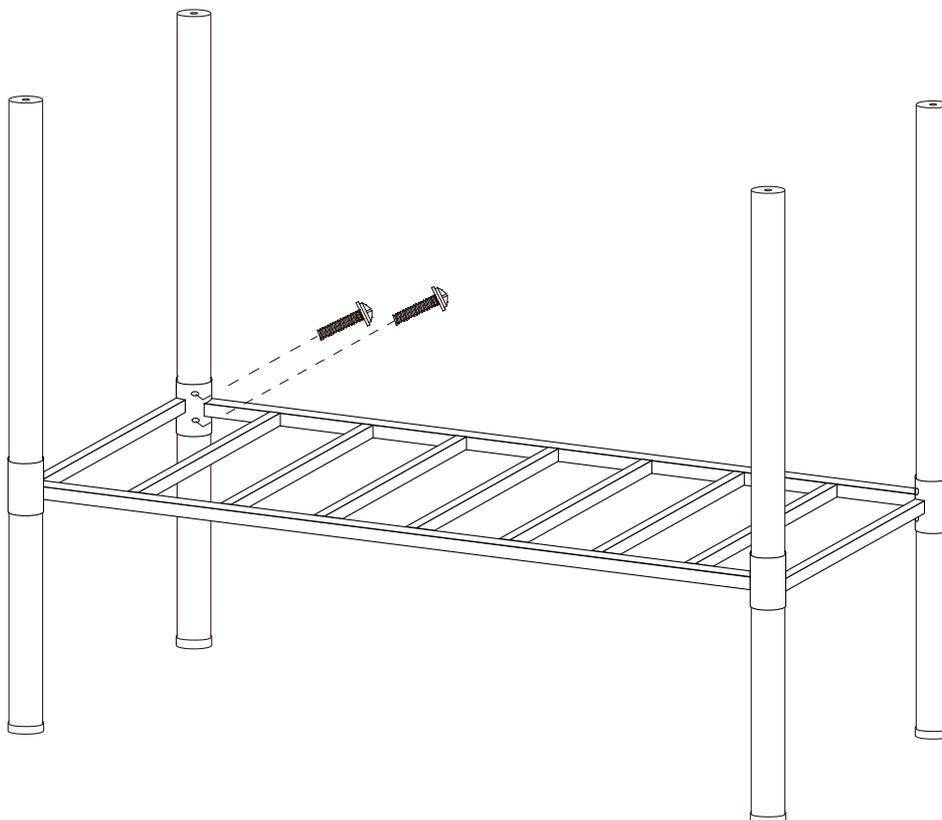
2. Montieren Sie das Bauteil „3“ mittels der Schraube „11“ gemäß der Zeichnung. Optional montieren Sie die Verbindungsplatten, um die Verbindungsböden der Outdoorküche zu montieren. (Die Verbindungsplatten sind Lieferbestandteil der Verbindungsböden Art.-Nr. 2304-04).
