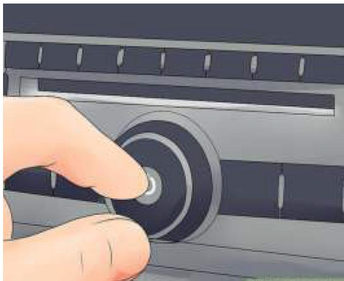
Testen Sie die Stereoanlage. Schalten Sie die ein und testen Sie die am, fm und cd Komponenten. Testen Sie die Fade- und Balance-Einstellungen, um sicherzustellen, dass dass die Lautsprecher richtig funktionieren. arbeiten. schalten sie das gerät aus.
