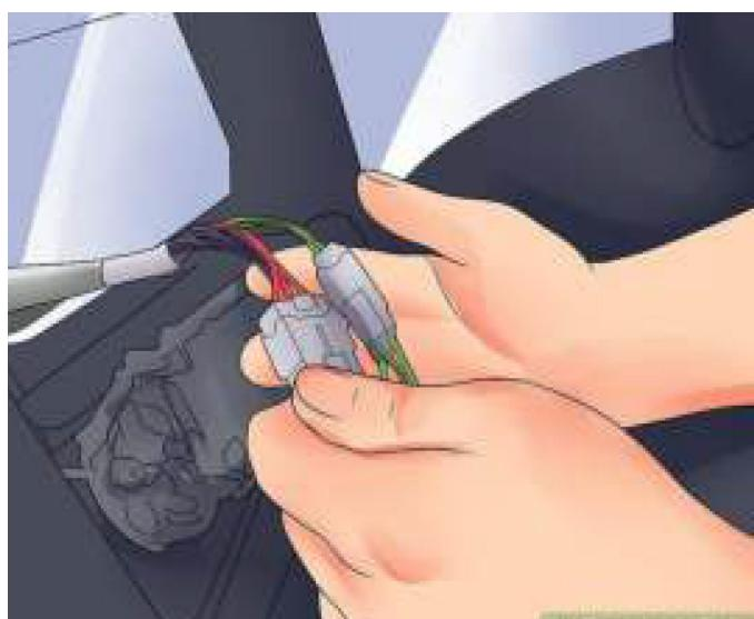
Wenn Sie einen Kabelbaum verwenden, wird diese Verbindung hergestellt, wenn Sie die Teile des Kabelbaums verbinden.
