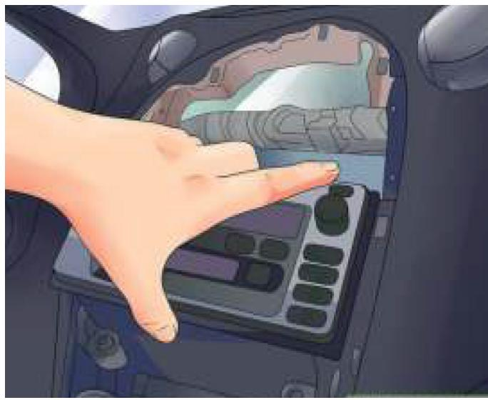
Trennen Sie die Stereoanlage ab. Verschiedene Fahrzeuge haben möglicherweise unterschiedliche
