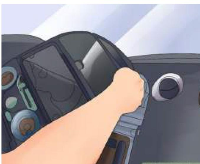
Retirez tous les éléments nécessaires composants. Si vous devez retirer des composants avant de pouvoir accéder à la chaîne stéréo, faites-le. Débranchez les composants qui sont connectés à la voiture. Prenez une photo du câblage pour une utilisation ultérieure.
