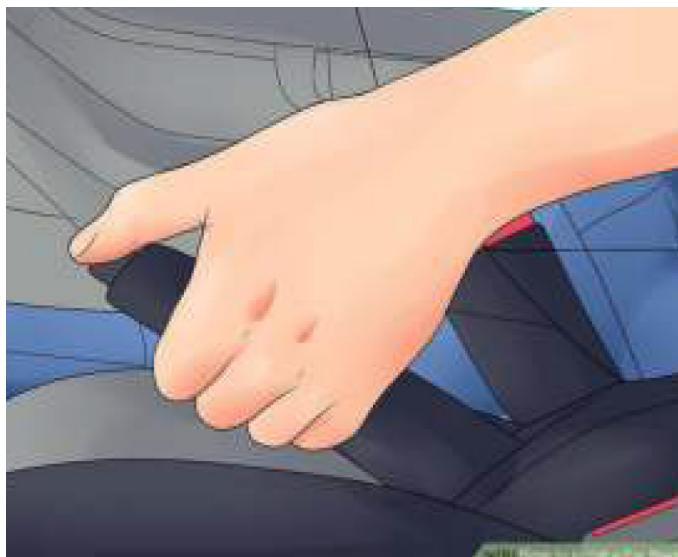
Ziehen Sie die Feststellbremse an und klemmen Sie das Kabel von der Fahrzeugbatterie ab. Achten Sie darauf, dass Sie dies tun, um zu vermeiden, dass die elektrische Anlage während des Einbaus kurzgeschlossen wird, was zu einem Brand oder zu Verletzungen führen könnte.
