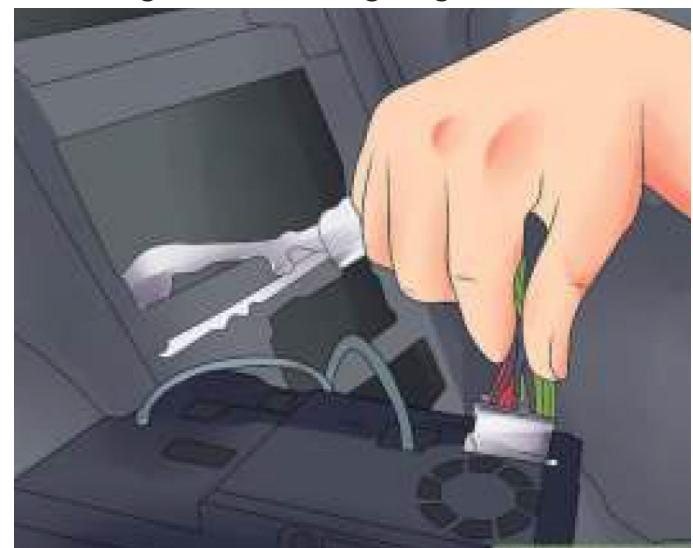
Schließen Sie das Antennenkabel an und verbinden Sie den Kabeladapter der Stereoanlage mit dem Kabelbaum des Fahrzeugs. Schließen Sie den Ausgangswandler anschließen, um die neue Stereoanlage mit dem mit dem Audiosystem des Fahrzeugs kompatibel zu machen.
