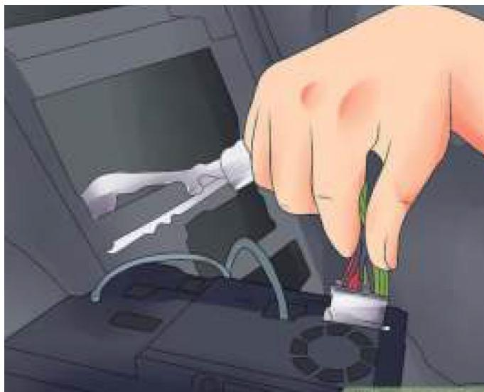
Connectez le câble de l'antenne et connectez l'adaptateur de câblage de stéréo au faisceau de câbles de la voiture. Connectez le convertisseur de sortie connectez si nécessaire pour rendre la nouvelle stéréo compatible avec le système audio de la voiture. système audio de la voiture. n'oubliez pas que tous les fils doivent être connectés à l'extrémité sont connectés et aucun ne doit être pendants.
