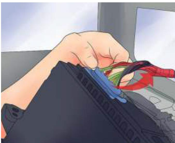
Trennen Sie die Anschlüsse der Stereoanlage.
