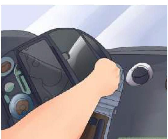
Ziehen Sie alle notwendigen Komponenten heraus. Wenn Sie Komponenten entfernen müssen bevor Sie auf die Stereoanlage zugreifen können, tun Sie dies. Trennen Sie die Komponenten, die mit dem Fahrzeug verbunden sind. Machen Sie ein Foto von der Verkabelung für die spätere Verwendung.
