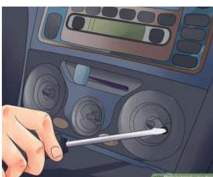
Stellen Sie sicher, dass Sie alle Schrauben entfernen, bevor Sie versuchen, die Abdeckung zu entfernen versuchen, sonst können Sie die Abdeckung.
