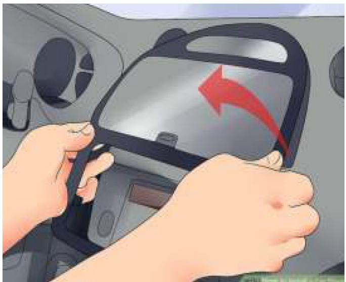
Bei einigen Fahrzeugen müssen Sie mehrere Teile der Kunststoffverkleidung entfernen, normalerweise von unten nach oben. Wenn Sie Verkleidungen entfernen müssen die Knöpfe oder Schubladen enthalten, entfernen Sie diese, bevor Sie bevor Sie versuchen, die Verkleidung abzuheben.
