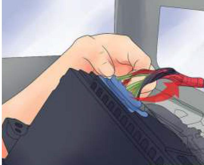
Débranchez les connecteurs de la stéréo. Il y a une série de fils connectés à l'arrière de la stéréo,
