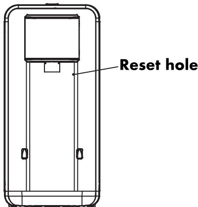
Das Gerät verfügt über einen manuellen Thermostat, um die Heizfunktion bei abnormalem Betrieb wiederherzustellen. Wenn das Gerät nicht mit Strom versorgt wird, nicht mehr funktioniert und das Wasser nicht kocht, können Sie den Thermostat zurücksetzen, indem Sie mit der Reset-Taste auf das Reset-Loch drücken.
