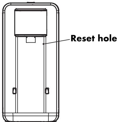
Het apparaat heeft een handmatige thermostaat om de verwarmingsfunctie te herstellen voor een abnormale werking, als de unit geen stroom heeft, stop niet werken, het water niet kookt, kunt u de thermostaat resetten met behulp van de reset-toets om op de reset-opening te drukken.
