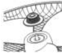
Fig.2 Serrer le cache-écrou dans le sens antihoraire
