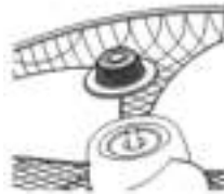
Fig.2 Afdekdop tegen de klok in vastdraaien
