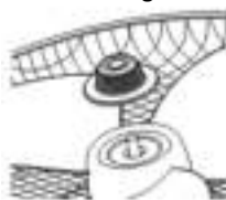
Abb.2 Ziehen Sie die Schützkappe gegen den Uhrzeigersinn fest
