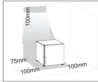
Allerdings sollte die Aufstellung des Geräts unter einem Hängeschrank nach Möglichkeit vermieden werden. Die ordnungsgemäße waagrechte Ausrichtung des Gerätes kann mithilfe eines oder mehrerer verstellbarer Füße am Sockel des Gehäuses erfolgen.
