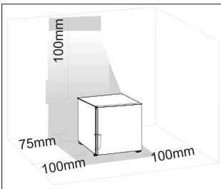
Voor de beste prestatie kunt u het apparaat echter beter niet onder een wandkast zetten. De afstelbare voetjes aan de onderkant van het apparaat garanderen een nauwkeurig horizontale uitlijning.
