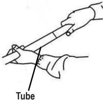
(4) Schlauch am Handrohr anschließen
