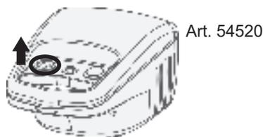
2. Retirez l'ancien filtre à l'aide d'un cure-dent par exemple.
