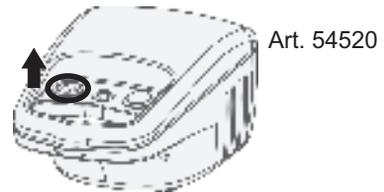
2. Entfernen Sie den alten Filter z. B. mit einem neuen Zahnstocher.
