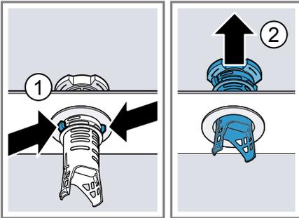
5. Unter fließendem Wasser die Siebelemente reinigen.
