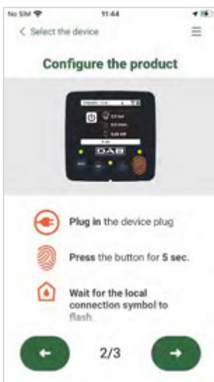
Anleitungen für den direkten Anschluss
