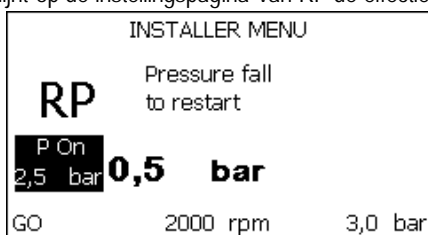
Afb. 18.1: Instelling van de herstartdruk (1)
