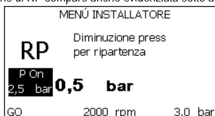
Figura 18.1: Impostazione della pressione di ripartenza (1)
