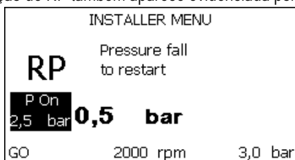
Figura 18.1: Programação da pressão de rearmar (1)
