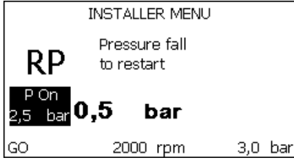
Şekil 18.1: Yeniden başlatma basıncının ayarlanması (1)
