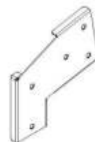
A100326 | SCHOMMELBALK (1) | VERLENGINGSBEUGE L - RECHTS
