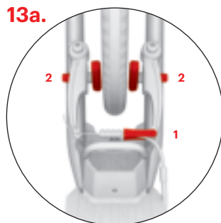
13a. Nastavenie brzdy (V-brzda)
