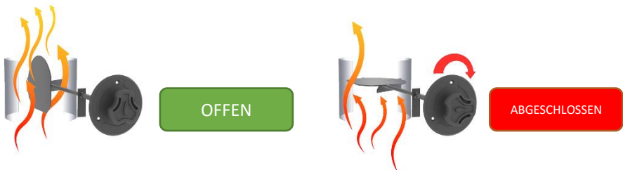
Abbildung III – 2.2. Steuerung des Ventils für die Rauchgase
