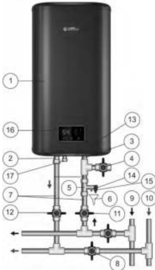
Paveikslas 1. EVŠ prijungimo prie vandentiekio schema
