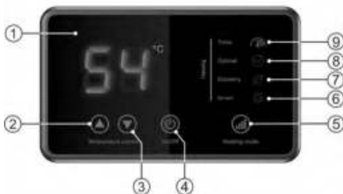
Figura 2. Pannello di comando elettronico
