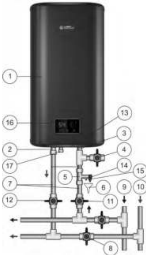
Attēls 1. EŪS pieslēgšana pie ūdensapgādes tīkla
