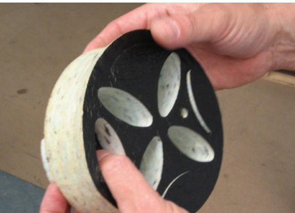
Verwijder het benodigde aantal pluggen
