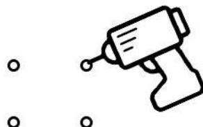
1. Neem de gaten van de bodemplaat over en boor deze met een 6mm steenboor.
