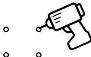
1. Copiez les trous de la plaque inférieure et percez-les avec une perceuse à maçonnerie de 6 mm.
