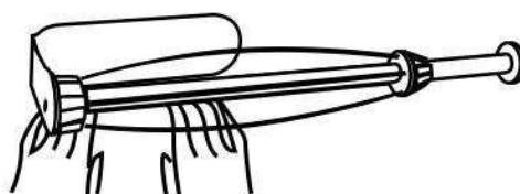
3. Appuyez le ruban adhésif sur la plaque inférieure, retirez la deuxième couche protectrice, chauffez avec le sèche-cheveux et appuyez fermement sur la surface.
