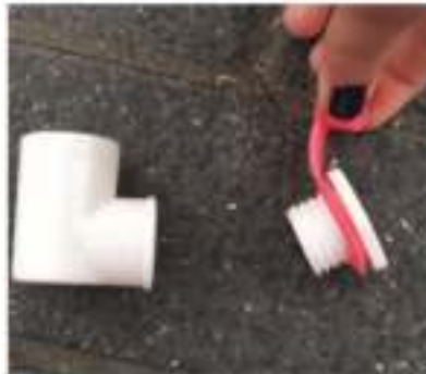
1. Draai het binnenstuk en het buitenstuk uit elkaar
