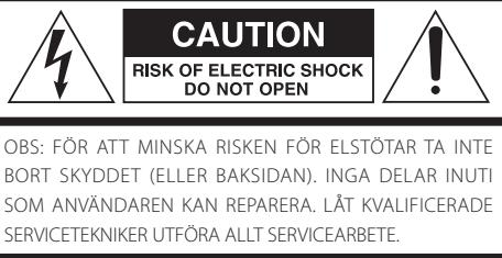
Den lysande lampan med pilsymbol inom en liksidig triangel är avsedd för att varna användaren för närväro av oisolerad "farlig spänning" inom produkten hölje som kan ha en betydande storlek för att skapa risk för elstötar för personer.
