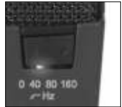
Fig. 3: Selettore per l'attenuazione dei bassi
