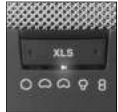
Abb. 1: Wahlschalter für Richtcharakteristiken
