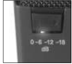
Fig. 2: comutador de seleção para pré-atenuação
