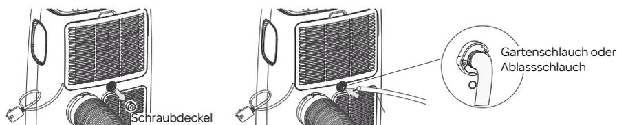
Während der Verwendung dieser Einstellung muss ein Gartenschlauch (nicht im Lieferumfang enthalten) oder etwas Ähnliches angeschlossen werden, um das entstehende Kondensat abzuleiten.
