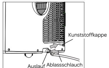
Das Ableiten von Kondensat ist auch auf die auf Seite 12 unter **ENTFEUCHTEN BESCHRIEBENE WEISE MÖGLICH**.
