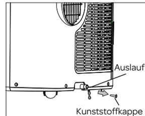
**Kontinuierliches Entleeren** - Dies ist die empfohlene Methode bei der Verwendung der Einstellung Entfeuchten.
