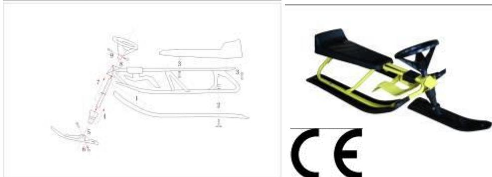
1. Befestigen Sie die Kufen links und rechts am Rahmen.(**Schritt 1**)
