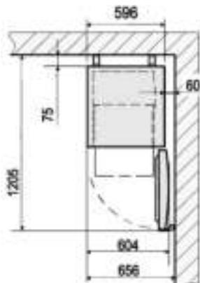
Falls der Kühlschrank seitlich an eine Wand gestellt wird, lassen Sie einen seitlichen Abstand von min. 60 mm, damit Sie die Kühlschranktür um 90° öffnen können. Um das Frischefach aus dem Gerät herausnehmen zu können, entfernen Sie das Flaschenfach.
