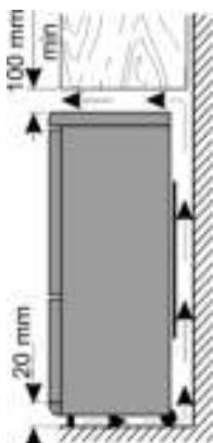
Die hinter dem Gerät aufgewärmte Luft muss frei zirkulieren können.
