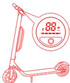
Allumez la trottinette et vérifiez le niveau de puissance du témoin. Chargez la trottinette si le niveau de la batterie est faible.
