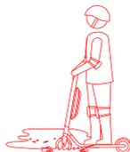
NE PAS rouler dans des flaques d'eau ou d'autres types d'eau d'une profondeur supérieure à 2 cm !
