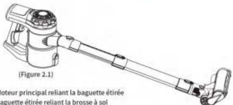
\*Assemblage de la brosse à plancher : Insérez la brosse à plancher dans le port de la baguette étirée directement.
