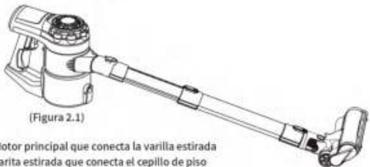
\*Montaje del cepillo de piso: Inserte el cepillo de piso en el puerto de la varilla estirada directamente.
