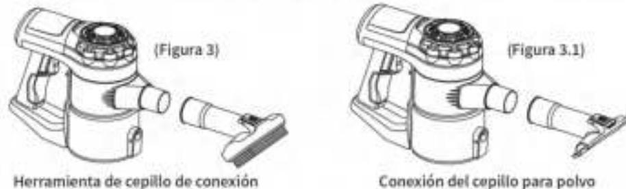
Para ensamblar estas dos herramientas, simplemente insértelas en el puerto del motor principal. La herramienta para rincones se puede utilizar para rincones y grietas como esquinas, cajones, ventanas, teclados y cojines del asiento, etc. (Figura 3.2)
