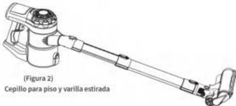
\*Desmontaje del motor principal y la varilla estirada: mientras una mano sujeta el motor principal, la otra mano saca la varilla presionando el botón de liberación en la varilla estirada (Figura 2.1)
