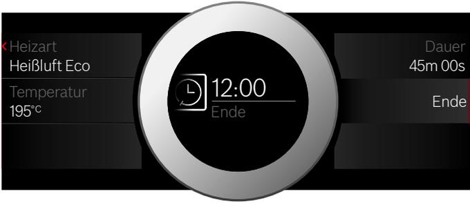
5. Mit Taste start/stop  $\triangleright$  starten. Im Display steht die Uhrzeit, zu der das Gerät startet.
