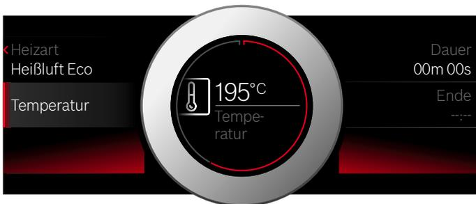
3. Mit Taste start/stop ▷ starten. Die Zeit im Display zeigt an, wie lange der Betrieb bereits läuft.
