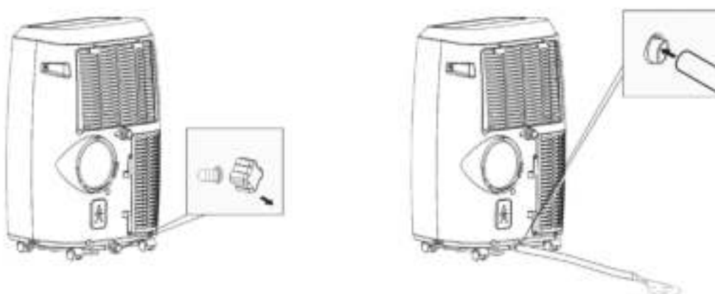
Figure 7 Écoulement de la cuve de sol
