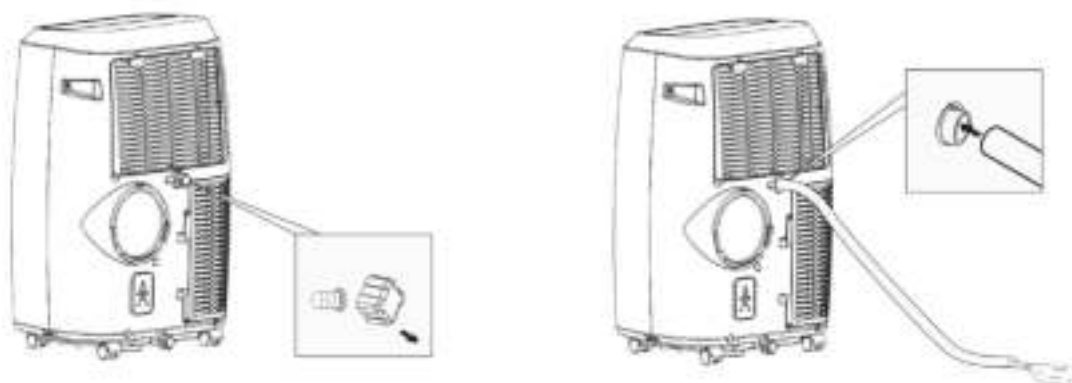
Figure 6 Évacuation de l'eau
