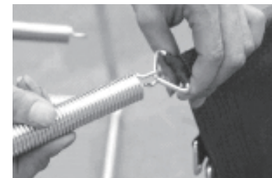
9. Dopo aver inserito tutte le molle nel telaio, stendere il tappeto da salto all'interno del telaio. Attaccare una molla ad un gancio della rete di sicurezza.
