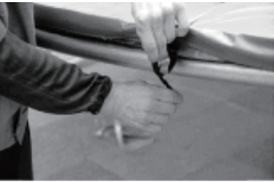
15. Fije la tapa del marco con las correas negras al marco o a las patas. No ate las plumas.
