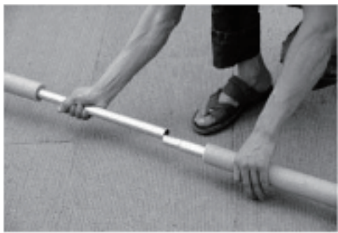
2. Coloque la tapa en el tubo superior y el botón final en el tubo inferior. Luego empuje los tubos juntos.
