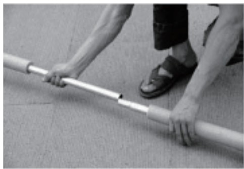
Stecken Sie jeweils die Endkappe auf das obere Rohr und den Abschlussknopf auf das untere Rohr. Anschließend schieben Sie die Rohre zusammen.
