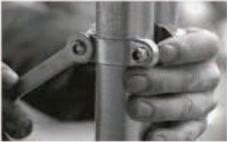
7. Fije la segunda abrazadera a la parte superior de cada pata de apoyo.
