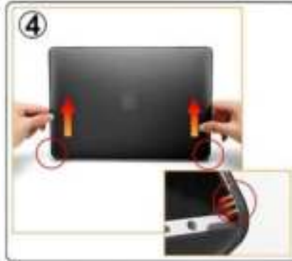
4. Ook bij de bovenste cover begin je bij de scharnieren, en ga je langzaam naar boven.
