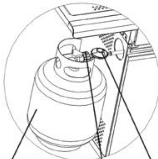
Bombola di gas Regolatore Tubo
