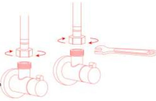
**NL)** Draai de moeren van de flexibele slangen stevig aan met een steeksleutel op uw waterleiding. Zet de hoofdkraan aan en bekijk of er eventueel nog water lekt.
