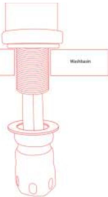
**NL)** Draai de flexibele slangen met de hand in de kraan.
