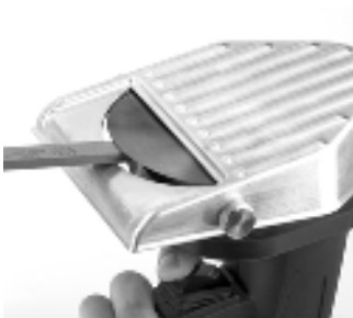
Das runde, glatte Schneidmesser ist ca. 1-2 Sekunden lang unter einem geringen Winkel in Bezug auf die horizontale Ebene zu schärfen.
