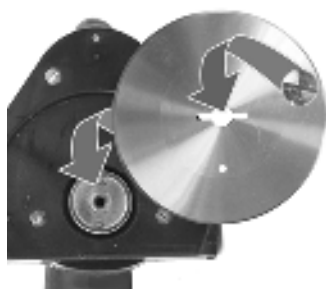
Załóż nowe ostrze, przykręć tarczę przytrzymującą i śrubę mocującą.
