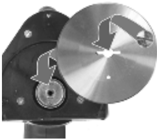
Plaats het nieuwe mes en schroef de borgschijf en bevestigingsschroef vast.
