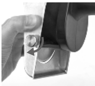
Fixez la protection de la lame
