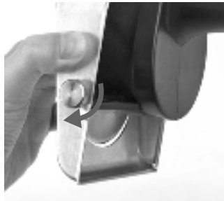
Τοποθετήστε το προστατευτικό κόφτη.
