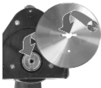
Introduceți cuțitul nou, înșurubați discul de fixare și șurubul.
