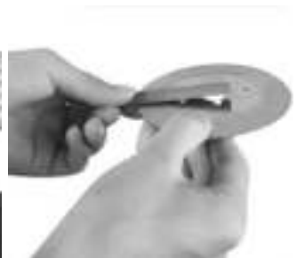
Den unteren Teil des Schneidmessers von vorn abschleifen.
