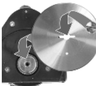
Das neue Schneidmesser anlegen bzw. die Haltescheibe und die Befestigungsschraube anschrauben.
