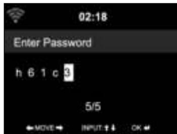
**Zum Eingeben des Passwortes** drehen Sie den Drehknopf zum gewünschten Zeichen. Die Pfeil-Tasten benutzen Sie, um weitere Zeichen einzugeben. Erst wenn Sie das Passwort vollständig eingegeben haben, drücken Sie den Drehknopf zur Bestätigung der Eingaben.
