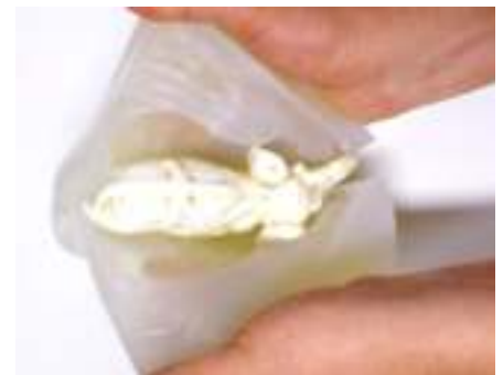
Fig. 4: De mal is aan de bovenkant (over de ruggengraat) van de olifant open gesneden zodat het kopje er uit getild kan worden.
