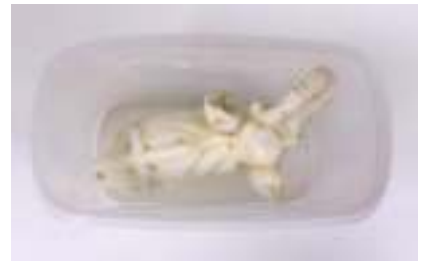
Fig. 2: Het model op plasticine balletjes in een bakje geduwd, gepositioneerd en voorzien van een lossingspray.
