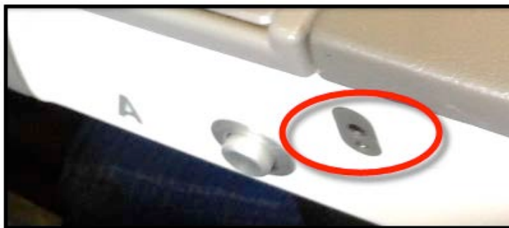
Figura 1.9 – Porta audio nella poltrona dell'aeroplano (bracciolo)
