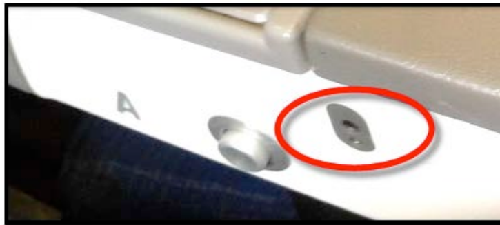
Рисунок 1.9 – Разъемы входа сиденья самолета (в подлокотнике)
