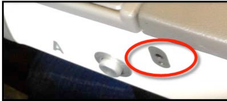
Figura 1.9 – Receptáculo de entrada en el asiento de avión (apoyabrazos)
