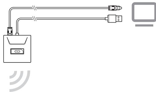
**IMPORTANT** La connexion par câble optique n'est possible que pour les écouteurs RIG 700HD et RIG 700HS.
