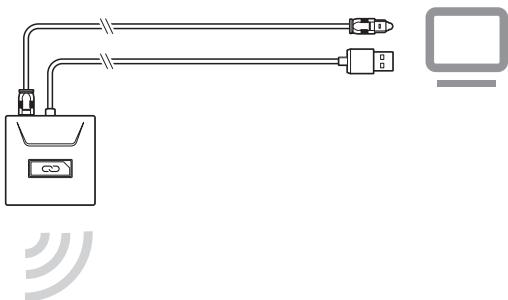
**IMPORTANTE** La connessione con cavo ottico è solo per i modelli RIG 700HD e RIG 700HS.
