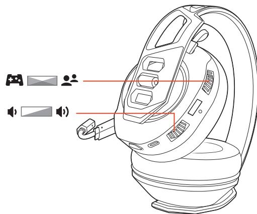
重要对于 PS4（纤薄款），将顶部的耳机拨盘调至中间位置；游戏和聊天保持音量均衡。使用底部耳机拨盘增大或降低主音量。
