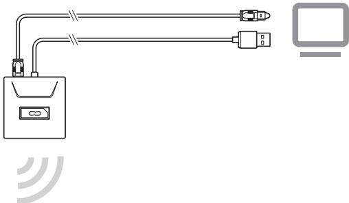
重要光缆连接仅适用于 RIG 700HD 和 RIG 700HS。
