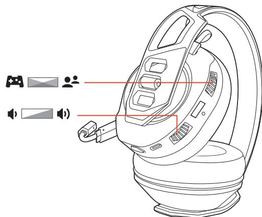
**重要事項** 若為 PS4 (slim 版)，請將耳機頂端的音量調節器設於中間；遊戲與聊天功能即可維持平衡。使用耳機底部的音量調節器調高或調低主音量。
