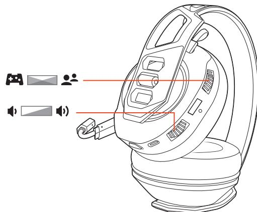
**IMPORTANT** Pour la console PS4 (version Slim), positionnez le bouton supérieur au milieu : le jeu et le clavardage demeurent équilibrés. Utilisez le bouton du bas pour augmenter ou réduire le volume principal.
