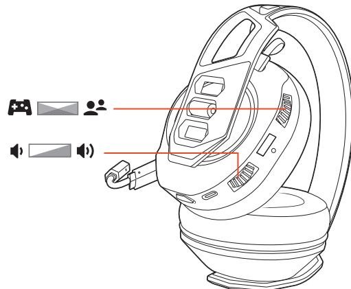
重要PS4（スリム バージョン）の場合、ヘッドセットの上のダイヤルを中央に設定します。こうすることで、ゲームおよびチャットの音量のバランスが維持されます。ヘッドセットの下のダイヤルを使用して、マスター音量を変えます。
