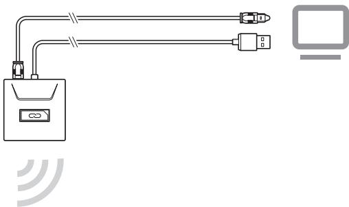
**BELANGRIJK** De optische kabelverbinding is alleen bestemd voor RIG 700HD en RIG 700HS.
