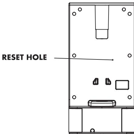
L'appareil est équipé d'un thermostat manuel qui permet de rétablir la fonction de chauffage en cas de fonctionnement anormal. Si l'appareil n'est pas alimenté, s'il ne fonctionne plus, s'il ne bout pas l'eau, vous pourrez réinitialiser le thermostat en utilisant la clé de réinitialisation pour appuyer sur le bouton de réinitialisation dans le trou.
