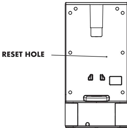
Het apparaat heeft een handmatige thermostaat om de verwarmingsfunctie te herstellen voor een abnormale werking, als het apparaat geen stroom meer heeft, stopt met werken, het water niet kookt, kunt u de thermostaat resetten met behulp van de reset-toets om op de reset-opening aan de achterkant van het apparaat te drukken.
