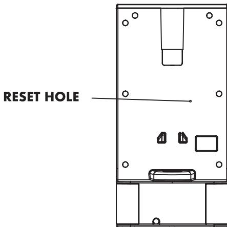
Das Gerät verfügt über einen manuellen Thermostat, um die Heizfunktion bei abnormalem Betrieb wiederherzustellen. Wenn das Gerät nicht mit Strom versorgt wird, nicht mehr funktioniert und das Wasser nicht kocht, können Sie den Thermostat zurücksetzen, indem Sie mit der Reset-Taste auf das Reset-Loch auf der Rückseite des Geräts drücken.
